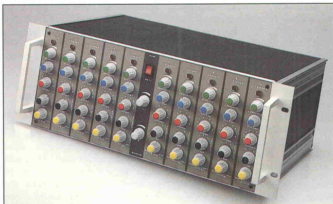
Bild 1. Die Elektronik für das digitale Schlagzeug umfaßt u. a. 63 Frontplattenelemente. Farbe bringt Übersichtlichkeit.
